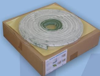
Il waterstop Wg2 composto dal 75% di bentonite sodica e dal 25 % di leganti elastomerici, è un giunto idroespansivo utilizzato per sigillare, da infiltrazioni d'acqua, le riprese di getto nelle costruzioni eseguite in calcestruzzo compensando eventuali irregolarità e vuoti tra un getto e l'altro.
